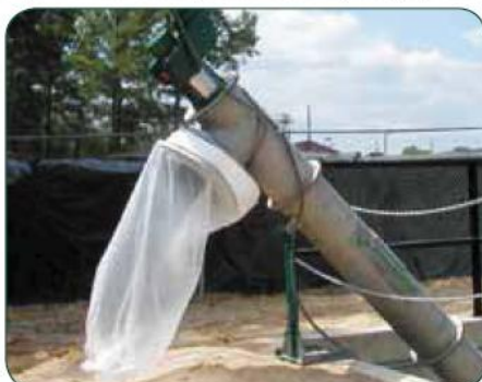
Выгрузка отходов в мешок.
