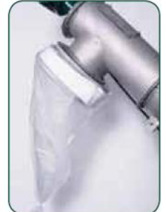
Выгрузка отходов в мешок
