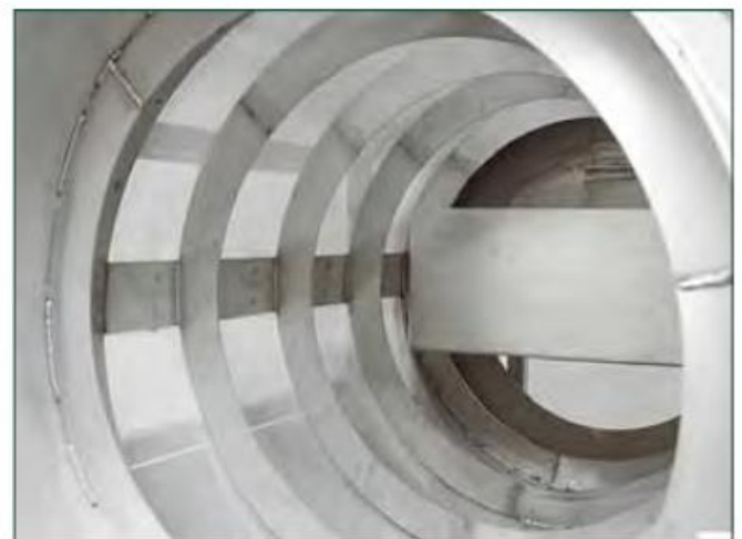
Сточная вода равномерно распределяется по всей поверхности тканой проволочной сетки или клиновидной сетки в зоне фильтрации.
