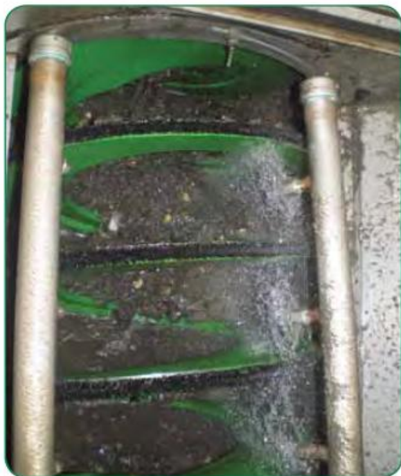
Крупный план шнека и системы струйной промывки Honey Monster. Неорганические вещества задерживаются, очищаются и удаляются.
